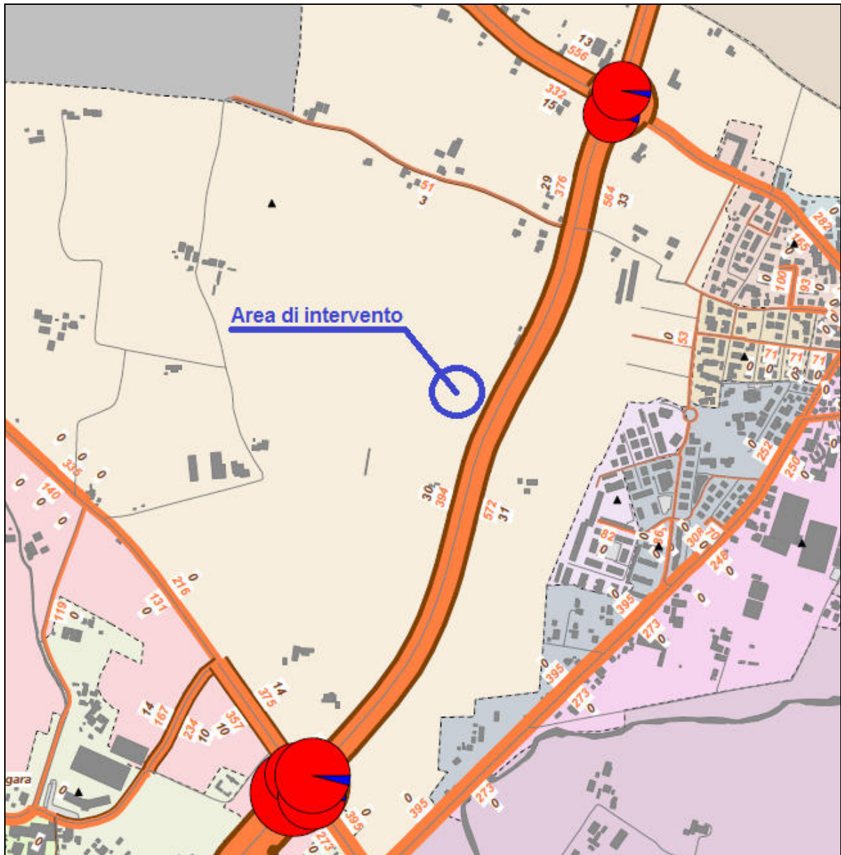
Figura 15 - Mappa di dettaglio con i volumi di traffico previsti dal PUM sulla viabilità locale
