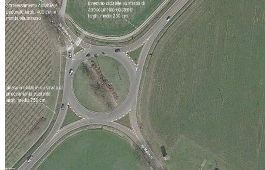
**DETTAGLIO A1 - CONNESSIONE A ITINERARIO CICLABILE DI RANGO TERRITORIALE ESISTENTE LUNGO VIA PER SCANDIANO / TORRENTE TRESINARO**
