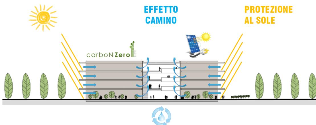
Gli edifici che verranno progettati, pertanto, si avvarranno dei principi della bioclimatica, sfruttando al meglio i fattori climatici naturali per il benessere indoor: ventilazione con effetto camino, schermature solari, effetto serra nel periodo invernale, areazione naturale anti-radon.
